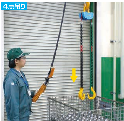
4点吊り フックを容器の少し手前まで下げる。
