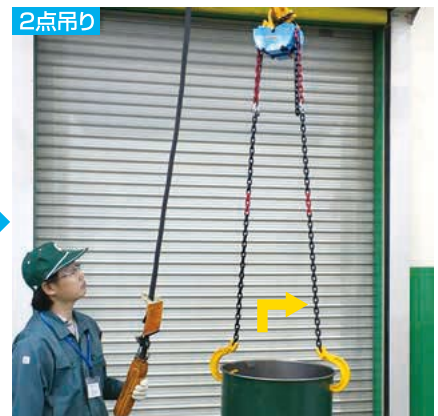
2点吊り 吊り上げて目的の場所へ移動。
