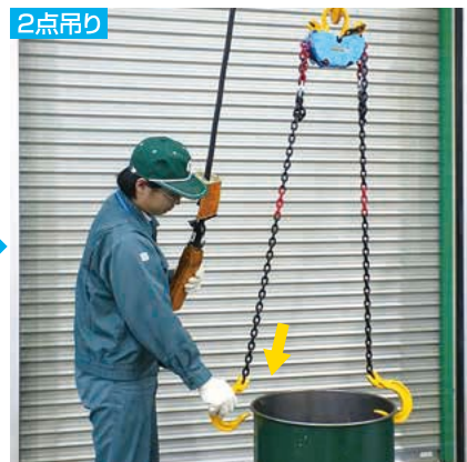
2点吊り フックを手で持って伸ばして容器の穴等へ掛ける。
