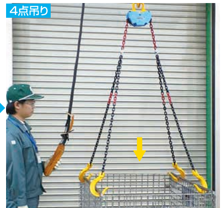
4点吊り バネの張力が無くなるまで下げて、フックをはずす。
