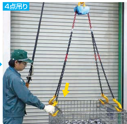
4点吊り フックを手で持って伸ばして容器の穴等へ掛ける。
